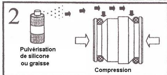
Comprimez la cartouche pour s'assurer que les joints augmentent de diamètre facilement. Lubrifiez les joints si nécessaire, par pulvérisation de silicone ou de graisse (par exemple Molykote)
