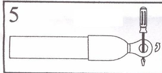
Vérifiez l'intérieur du tubage, insérez la tête de tirage et assurez-vous que le joints d'étanchéité ne soit pas expansé. Glissez entièrement la tête dans le tubage et serrez. La tête de tirage est maintenant opérationnelle.
