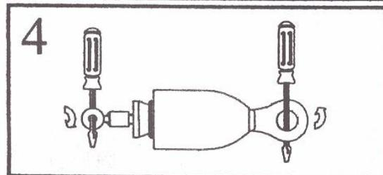
Assemblez la tête de tirage, et s'assurer que la cartouche de joints est montée dans le bon sens. Le cône sera serré jusqu'à toucher les gripeurs puis l'oeil arrière sera fortement serré sans qu'il ne touche pas le cône
