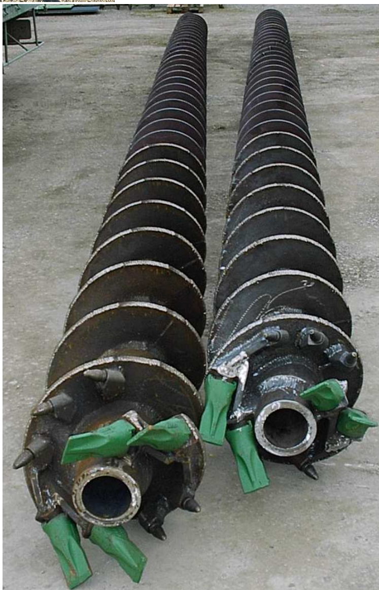
Fond conique – éjection béton droite Longueur monobloc de 14m
