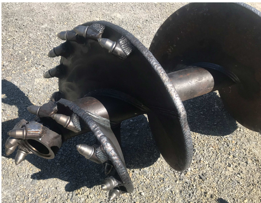
Fond conique roche – éjection béton latérale
